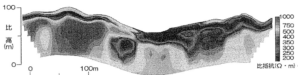
図 3.4.1 比抵抗二次元探査測定例 11)
