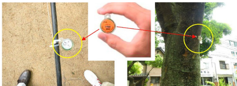
写真4.1.1-1 水中温度計設置状況
