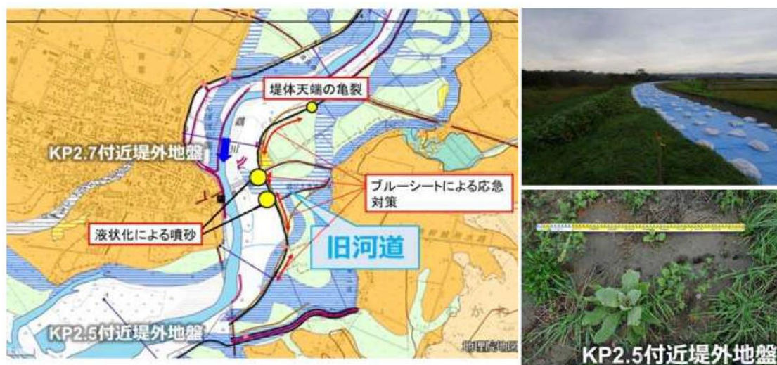
図-8 北海道胆振東部地震における液化化事例（むかわ町 鵠川）
