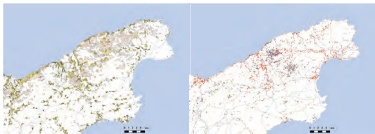
【能登半島東部】地すべり分布+土砂災害警戒区域（左図）と令和6年能登半島地震で発生した斜面崩壊・亀裂分布（右図）の比較
