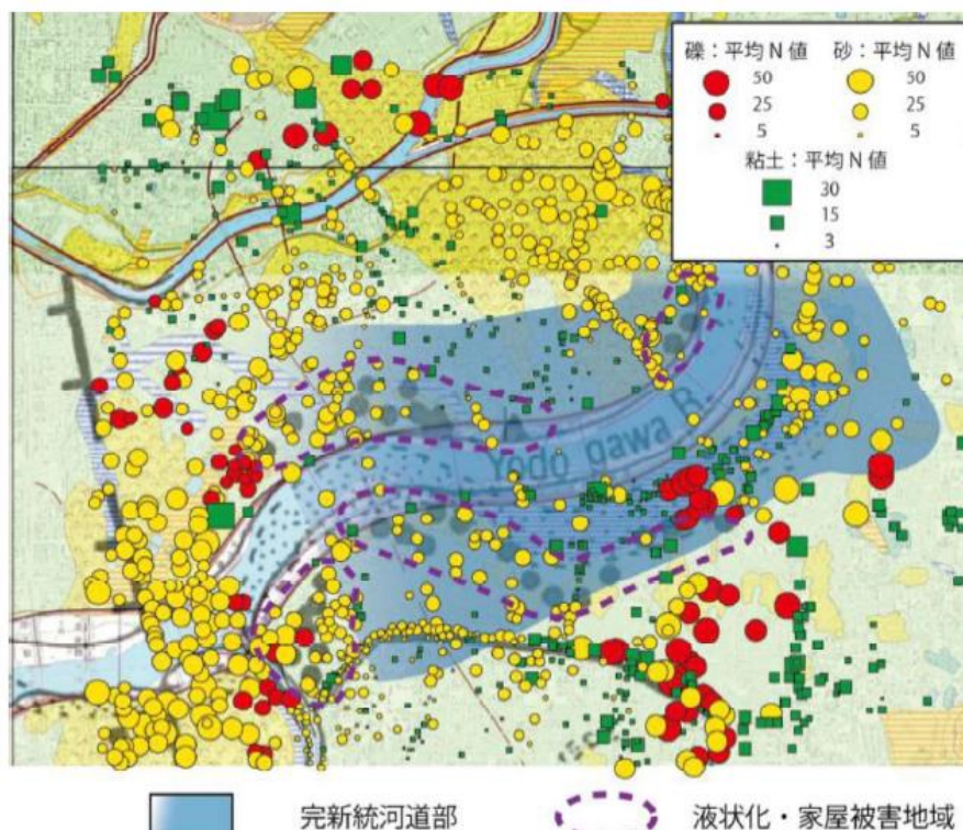
図-7 完新統河道部と液化化・家屋被害分布と治水地形分類図に GL-5～10m の主要土層を重ねた図
