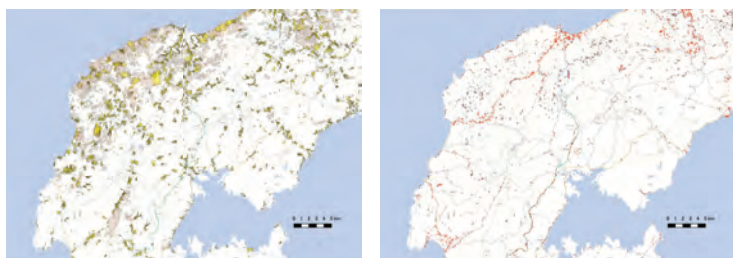
【能登半島西部】地すべり分布+土砂災害警戒区域（左図）と令和6年能登半島地震で発生した斜面崩壊・亀裂分布（右図）の比較
