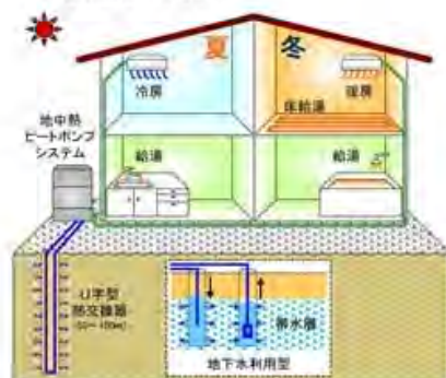
■再生可能エネルギー 地中熱ヒートポンプ
