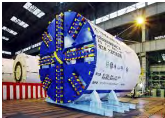
写真2 シールド機 (φ6,000mm)
