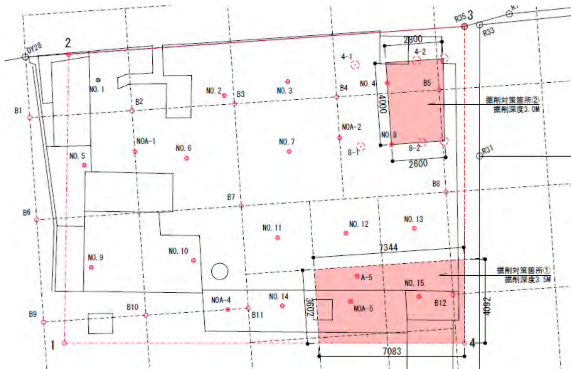
図4 掘削除去の施工範囲
