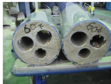
写真-2 充填状況
