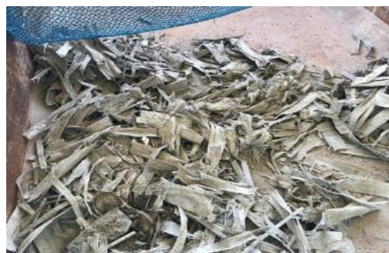
写真-1 シールド発生土から分別したPBD
