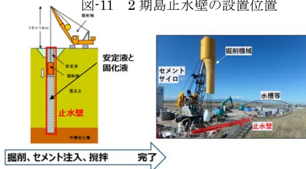
図-12 自硬性泥水固化工法のイメージ
